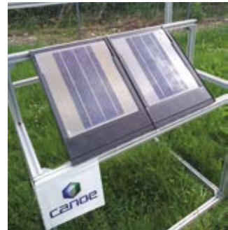
Tuile photovoltaïque à base de matériaux acryliques recyclables (projet ISOCEL)
