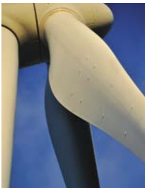
Pale d'éolienne équipée de penons électroniques
